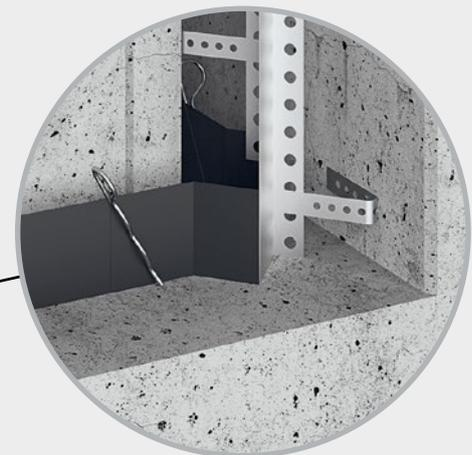
Im Fußpunkt wird das Dichtblech mit dem Sohle-Wand-Dichtblech überlappend verklebt und mit Stoßklammern gesichert.
