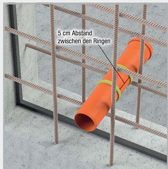
MASTERSTOP SK wird innerhalb der Bewehrung mit 6 cm Betondeckung um das Rohr geklebt.
