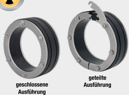
**Einbau:** Nach dem Einlegen der Ringraumdichtung und dem Durchführen des Mediumrohres werden die Schrauben über Kreuz angezogen. Jede Schraube mehrmals um eine Umdrehung anziehen, damit sich der Dichterring gleichmäßig auspresst. Maximales Drehmoment M6 = 5 Nm, M8 = 10 Nm, M10 = 15 Nm, M12 = 20 Nm. Nach 1 – 2 Stunden noch einmal nachziehen.
